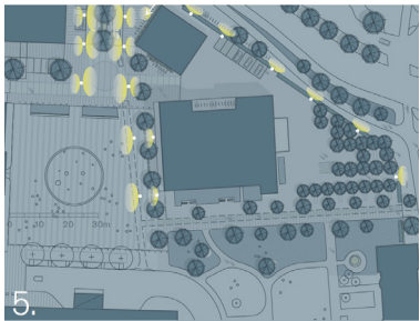
Axonometrisk ritning. Bågarna bidrar till den allmänna belysningen på torget, vilket medverkar till ökad orienterbarhet och trygghet. De lyser behagligt vitt under dygnets mörka timmar, och lyser upp i regnbågens färger när den aktiveras.
